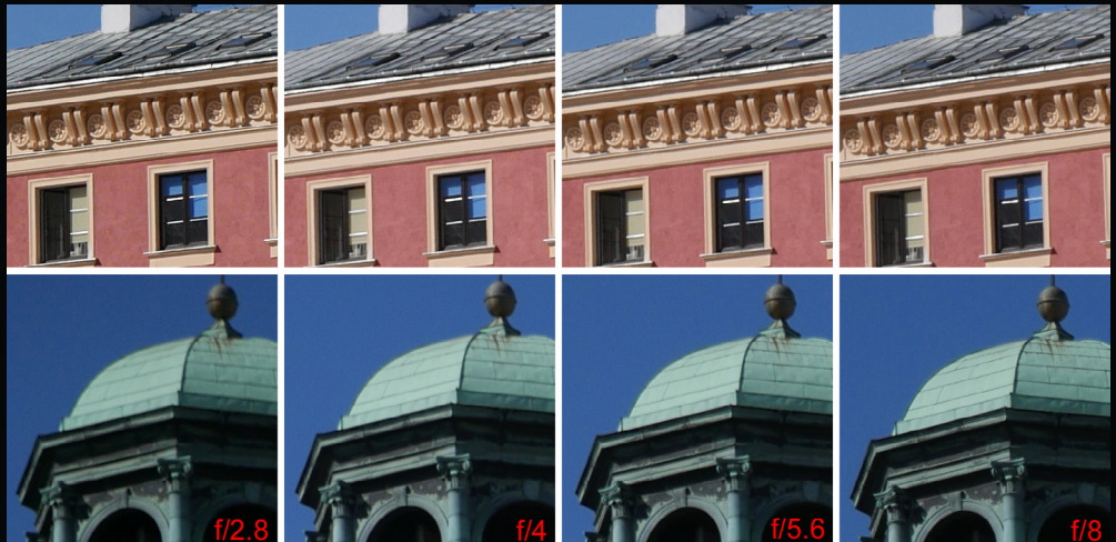
Wycinki ze zdjęć z zooma standardowego, z centrum kadru (górne) i z obrzeża (dolne) dla czterech otworów przyston i ogniskowej 35 mm.
