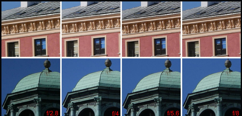
Wycinki ze zdjęć z telezooma, z centrum kadru (górne) i z obrzeża (dolne) dla czterech otworów przyston i ogniskowej 35 mm.
