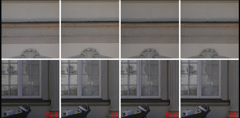
Wycinki ze zdjęć z telezooma, z centrum kadru (górne) i z obrzeża (dolne) dla czterech otworów przysłon i ogniskowej 60 mm.
